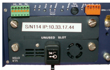
Fig. 15 Module OTDR monté + Manuel Utilisateur
