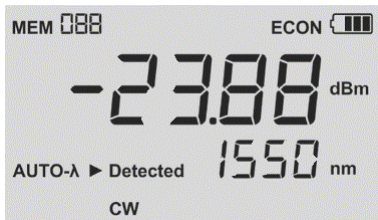
Bild 4 Anzeige des Absolutpegels in dBm.
