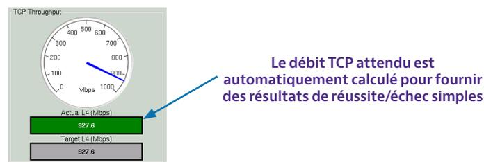
Figure 20. Statut de réussite/échec simple pour le test TrueSpeed RFC 6349
