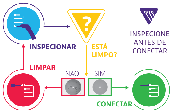
Figura 3: Exemplo de modelo de inspeção proativa: Inspect Before You Connect™
