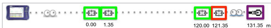
图 9. 在 Enterprise SLM 中查看包含 MPO 模块盒的高分辨率链路测试
