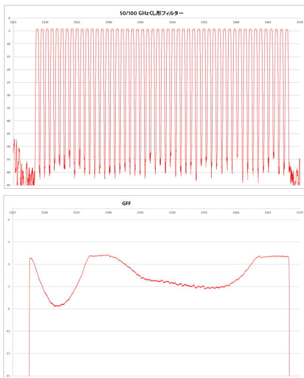
図7. フルスペン形状の例:くし形フィルター(上)と利得等化フィルター(下)
