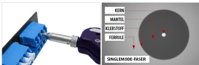
Abbildung 7: Prüfung durch den Einbausteckverbinder/Adapter mit dem Videomikroskop
