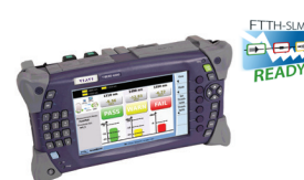
MTS-4000 con OTDR y medidor de potencia PON, o FiberComplete y medidor de potencia PON Plataforma modular de pruebas con pantalla grande que se adapta a módulos duales para medidas de nivel de potencia PON y OTDR únicamente u OTDR bidireccional, y pérdida de retorno o por inserción
