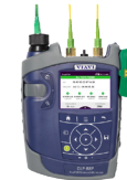
SmartClass Fiber OLP-88 Medida del nivel de potencia de PON, verificación del proceso de activación de ONT en GPON, identificación de ONT/ONU, detección de ONU no autorizadas/desconocidas, e inspección de conectores con análisis de tipo pasa/falla
