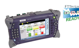
MTS-4000 avec OTDR et photomètre PON ou FiberComplete et photomètre PON Plateforme de test modulaire pouvant contenir deux modules pour les mesures de niveau de puissance PON, de réflectométrie uni- ou bi-directionnelle et de perte d'insertion et de réflexion
