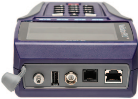
Test su cavi in fibre e rame (cavi coassiali, telefonici e di rete)
