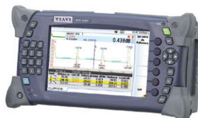
用于测试光纤、铜缆和多项业务的 MTS-4000 双插槽模块化手持式平台
