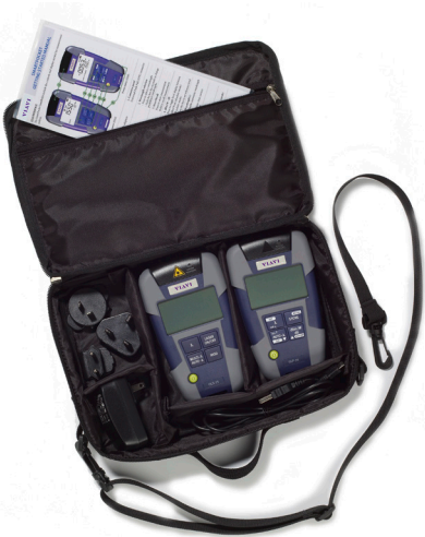
Optischer Messkoffer OMK-3x mit Lichtquelle, Pegelmesser, Netzteil und USB-Kabel.
