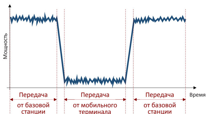
Рисунок 2. Структура сигнала LTE-TDD во временном интервале
