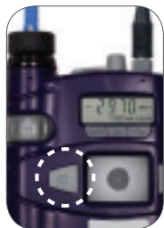
启动探针式光纤检查显微镜
