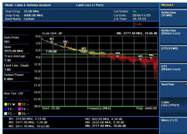
Kabel- und Antennentest: Kabeldämpfung
