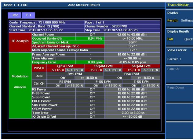
HF- und Modulationsanalyse: Automatische Messungen
