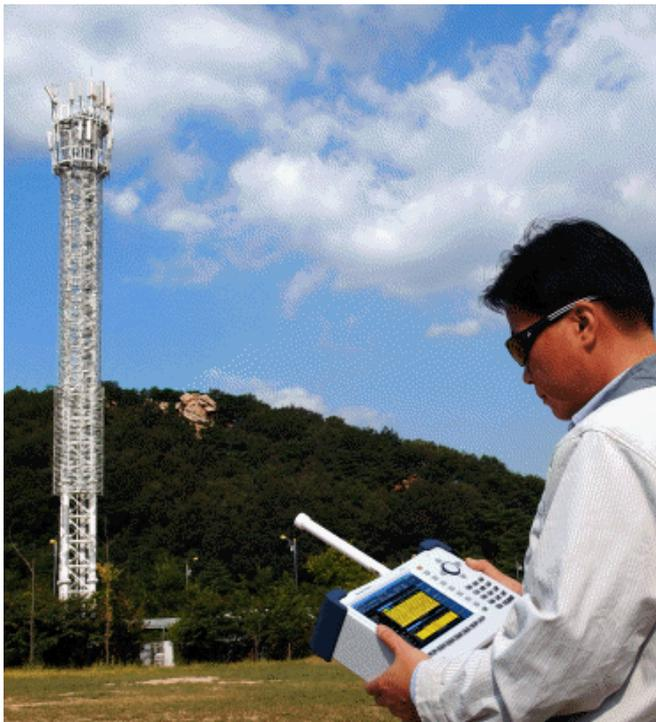
Der Anzeigemodus für Außenarbeiten erleichtert das Ablesen bei direkter Sonneneinstrahlung
