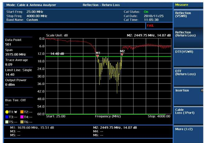
Kabel- und Antennentest: Reflexion
