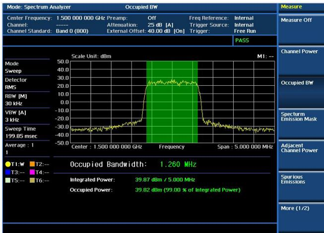
HF-Analyse: Belegte Bandbreite
