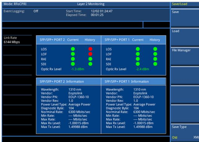
RFoCPRI: Überwachung der Layer 2
