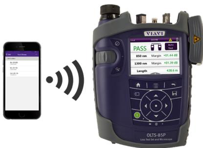
Automatische Synchronisation der Testergebnisse mit der Cloud
