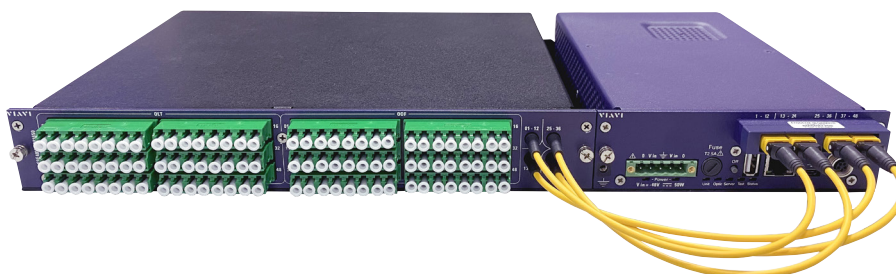
FTH-5000 mit TAP (48 Ports) und MPO-Schalter für 48 Ports
