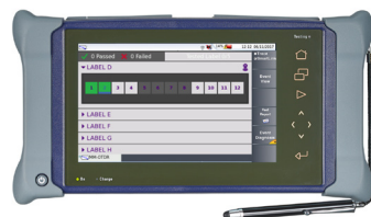
Handliche, modulare Plattform MTS- 4000 V2 mit zwei Steckplätzen zum Testen von Glasfasernetzen
