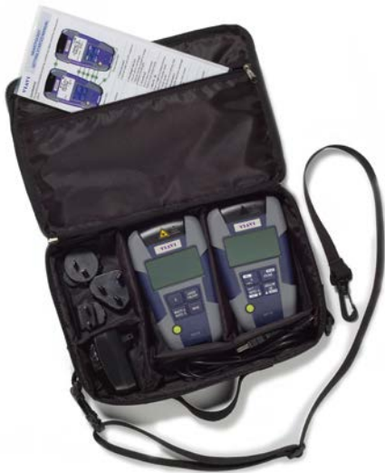
Optischer Messkoffer OMK-3x mit Lichtquelle, Pegelmesser, Netzteil und USB-Kabel.
