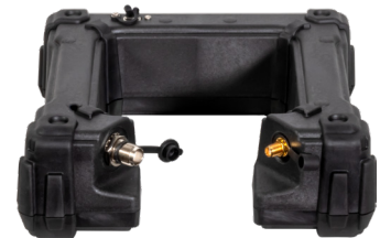
Direkter Anschluss des OSPREY an Ihr GPS-System und Einsatz als autonomer GPS-Simulator
