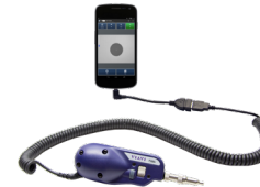
P5000i mit FiberChek™ MOBILE Steckverbinderprüfung mit Gut-/Schlecht-Auswertung
