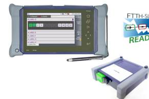
MTS-4000 V2 mit OTDR und PON-Leistungspegelmesser oder FiberComplete und PON-Leistungspegelmesser Modulare Testplattform mit großem Display für zwei optische Module für unidirektionale oder bidirektionale OTDR-, IL- und ORL-Messungen mit Unterstützung eines integrierten MPO-Schaltmoduls
