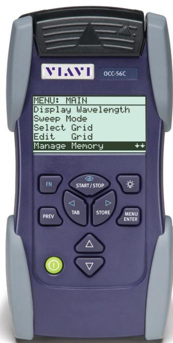
Analisa a presença, os níveis (dBm) e as frequências (THz/nm) dos canais ópticos do sistema DWDM (Dense-WDM).
