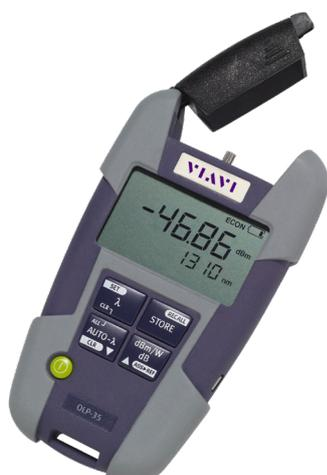
Verificar a potência de saída/entrada de equipamentos/fibras ópticas.
