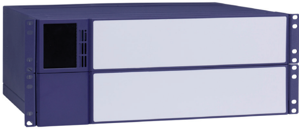
図 6b. 76 出力ポート以上のスイッチには 4U MAP-204C を使用できます。
