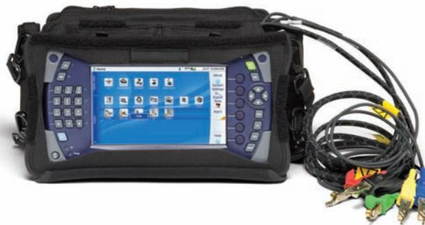
Der MTS-4000 erlaubt den Aufruf der Testfunktionen auf Tastendruck für die Installation, Inbetriebnahme und Wartung von Glasfaser- und Kupfer-basierten Netzwerken und von Triple-Play-Diensten.
