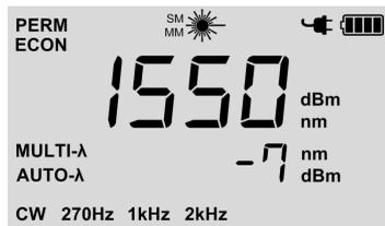
Abb. 2 Messanzeige OLS-34/-35 (mit allen Anzeigeelementen)
