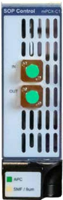
在其核心, mPCX-C1 级联八个四分之一波片; 每个都在 C+L 波段校准。采用铌酸锂光电波片, 响应时间可满足最严苛的偏振管理应用的要求。这些波片可以高速旋转, 并且可以自由复位 (无限旋转), 以控制偏振状态 (SOP)。
