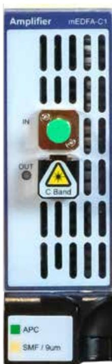
MAP 掺饵光纤放大器 (mEDFA) 模块将传统 VIAVI 台式模块的光学性能与 MAP 系列的灵活性和模块性相结合。EDFA 的变体针对不同的应用，例如放大器仿真、OSNR（光信噪比）实验和网络一致性测试。
