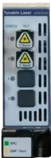
mTLG-C2 以取样光栅分布布拉格反射镜 (SGDBR) 激光器为基础, 带有一个集成式波长锁定器。可通过 MAP 系列本地接口或自动化接口来控制波长和输出功率设置。集成式波长锁定器和自动功率控制环路使得其运行十分稳定。mTLG-C2 模块是新一代可调谐激光器模块, 非常适合进行性能发生变化的 DWDM 测试。
