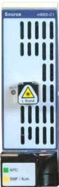
mBBS-C1 在扩展的 C 波段和 L 波段提供 100mW 的放大自发辐射 (ASE) 输出。mBBS 的光输出是超稳定的消偏振光输出信号，具有小于 1.8dB 的谱平坦度（图 1a 和 1b），功率稳定性优于 0.02dB。这些特点使得其非常适合于若干应用，其中包括光信噪比合规性测试期间的噪声加载、光放大器在增益期间的功率加载，以及噪声指数测量或无源器件特征分析。由于拥有非常出色的功率稳定性，因此这种光源通常用于功率计和可变衰减器的光学校准。
