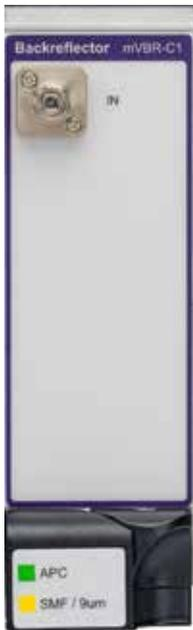
连同发射器/接收器和鉴定设备一起，MAP 背向反射器可用于确定显著降低传输系统性能的反射幅度，并表征其引起的问题。
