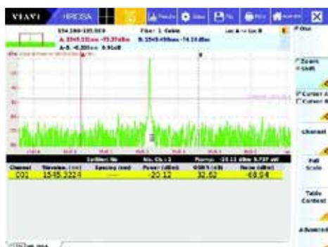
带有以表格形式呈现的波长、功率和分辨率图表的波长计 GUI
