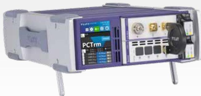
PCT-rm 将 mOLM-C1 测量模块与 MAP-220C 机箱中的 mSRC-C2 光源模块组合在一起交付，为用户提供了在紧凑系统中进行 IL 和 RL 测试所需的所有功能。
