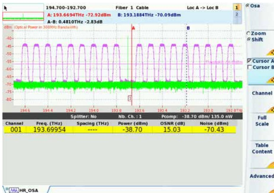
图 10 – 使用 mTFX 中的形状模式组合梳状滤波器和低通高通滤波器，从而去除单通道。显示在 HROSA 上
