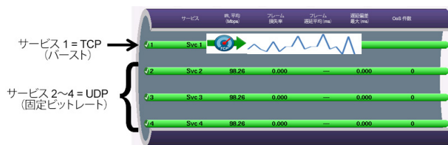
図 19. TrueSpeed サービスと組み合わせられた Y.1564 パフォーマンステスト
