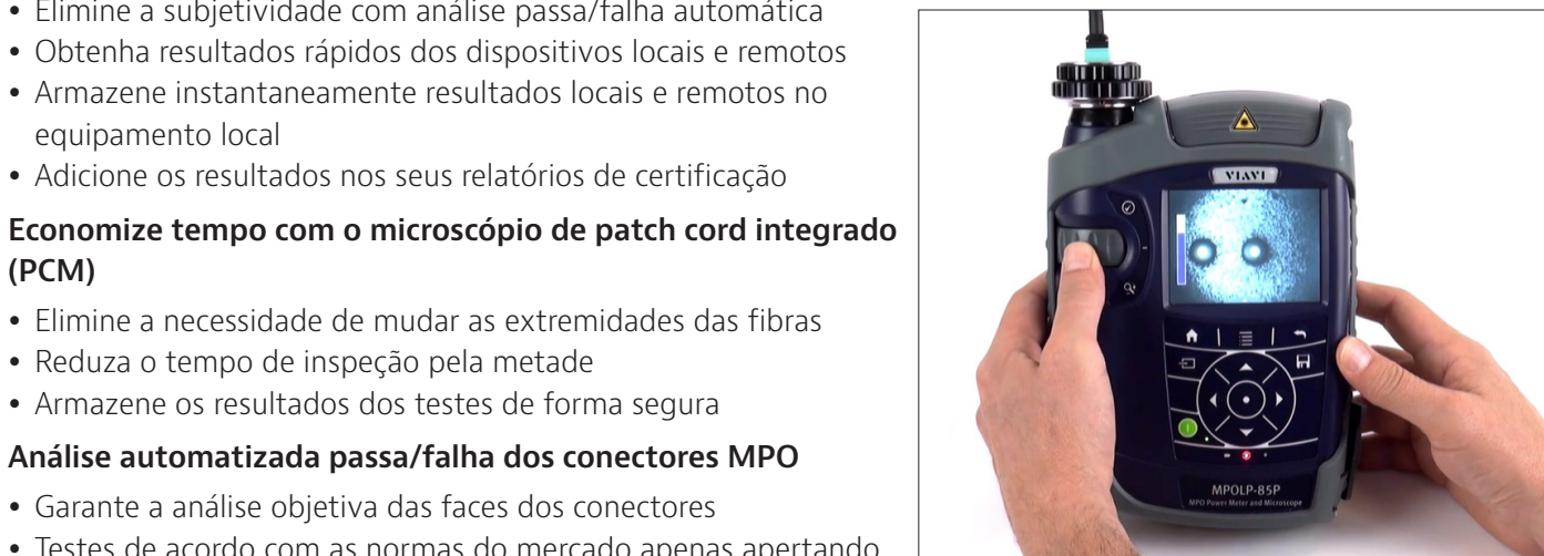
Inspeção do conector MPO com o PCM integrado
