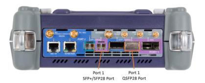
Figure 5: T-BERD 5800-100G mainframe
