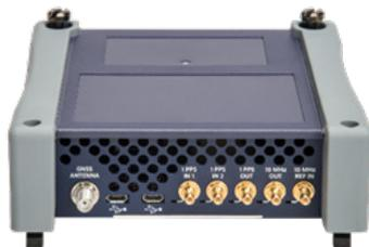
TEM は、同期測定用の基準信号を提供するだけでなく、GNSS アンテナとケーブルシステムの適切な設置を検証するためにも使用できます。そのスカイプロットと信号強度図は、目に見える衛星とそれぞれの信号強度の正確な画像を提供します。TEM は、時刻 (ToD) と 1PPS および 10MHz 基準信号を、次のセクションで説明する接続されたメインフレームに配信します。1PPS および 10MHz 信号は、外部テスト機器用の SMB ポートでも利用できます。
