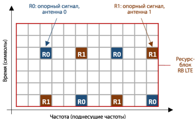
Опорные сигналы LTE MIMO
