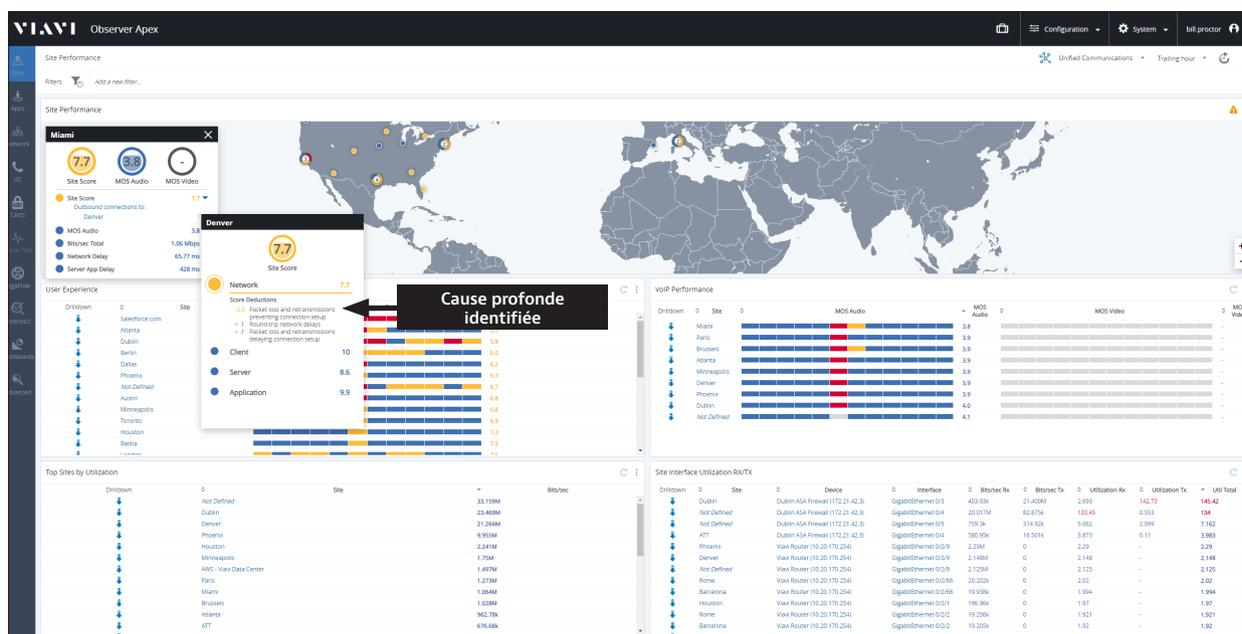
Les tableaux de bord d'Observer intègrent de manière homogène des données de flux d'infrastructure et des analyses basées sur les paquets. Dans le cas présent, un problème réseau est la cause de la dégradation de l'audio.
