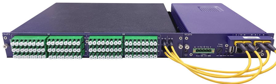
FTH-5000 com um TAP de 48 portas (ponto de acesso de teste) e chave óptica MPO de 48 portas
