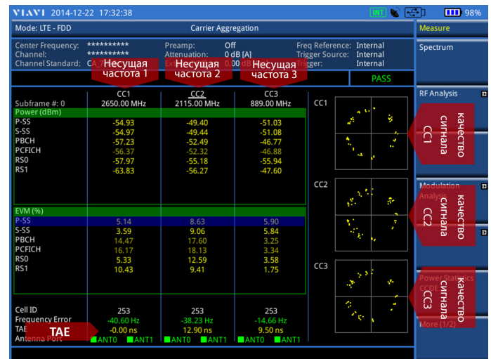
Отображение агрегации несущих частот сети LTE-A на экране анализатора CellAdvisor
