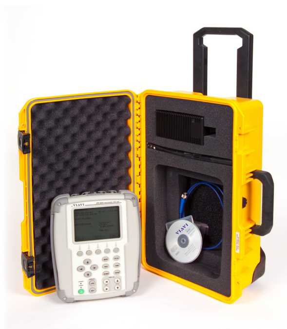
Entre los accesorios de serie, se incluyen un robusto maletín de transporte y una antena.
