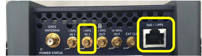
1PPS via SMB oder RJ45 gemäß G.703
