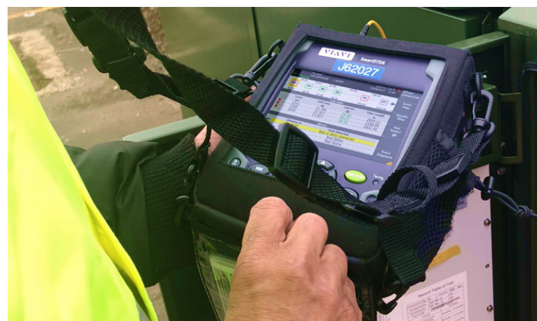
El ingeniero jefe puede visualizar de forma remota la interfaz de usuario del OTDR de un técnico nuevo desde la mesa de su oficina.
