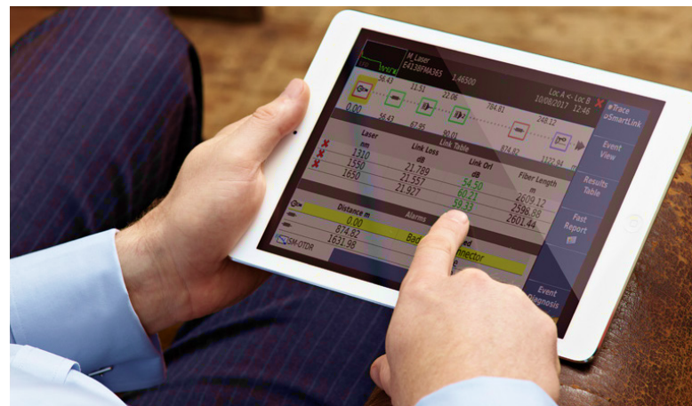
El ingeniero jefe puede visualizar de forma remota la interfaz de usuario del OTDR de un técnico nuevo desde la mesa de su oficina.
