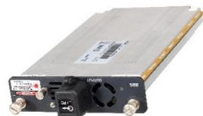
Es una fuente de banda ancha óptica de alto rendimiento que abarca el rango más amplio de longitudes de onda (de 1260 a 1640 nm) para calificar realmente el rango de longitudes de onda efectivo, incluida la absorción de humedad (OH-).
