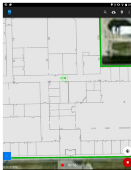
En la pantalla de la tableta o del teléfono Android, se muestra el plano de planta con la ubicación del usuario.
