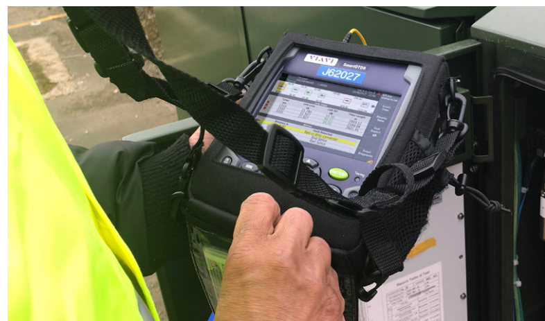
Un technicien expérimenté ou un chef d'équipe peut visualiser l'interface utilisateur d'un réflectomètre à distance, depuis le terrain ou le bureau
