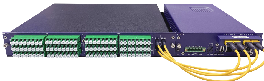
FTH-5000 avec TAP (point Test Access) de 48 ports et commutateur optique pour câble MPO de 48 ports
