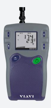
Les détecteurs Seeker X et les supports mobiles peuvent être intégrés dans des systèmes utilisant actuellement Seeker D, sans que cela n'affecte les processus existants de surveillance et de localisation/correction de problèmes. Ces nouvelles unités Seeker X bénéficient ainsi d'une vitesse, d'une sensibilité et d'une détection OFDM améliorées, et peuvent surveiller deux fréquences marquées supplémentaires si les marqueurs CT-4 sont remplacés par des unités CT-X compatibles avec les Seeker D.
