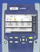
Handheld OTDR SmartOTDR
