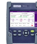
Optiméter Photomètre sélectif avec mode Termination G-PON/XG(S)-PON, certification complète/dépannage complet du raccordement optique à l'abonné
