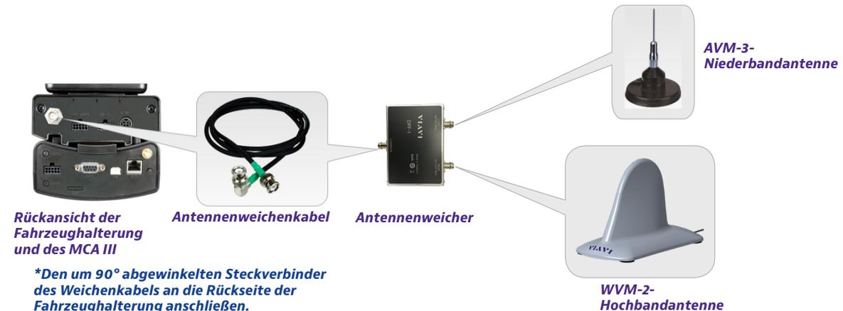
*\*Den um 90° abgewinkelten Steckverbinder des Weichenkabels an die Rückseite der Fahrzeughalterung anschließen.*
