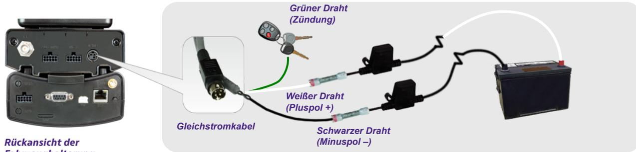
Rückansicht der Fahrzeughalterung und des MCA III
