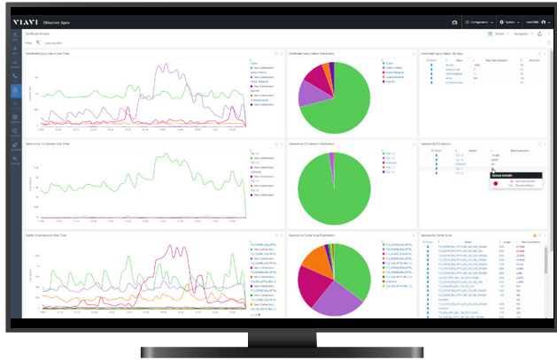
La dashboard di analisi dei certificati fornisce la versione TLS, la situazione relativa alla scadenza dei certificati e le implementazioni della suite di cifratura.
