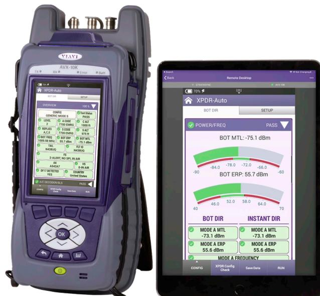
AVX-10K をお気に入りのモバイルデバイスに接続して使用すると、テストセットに簡単にリモートアクセスできます。
