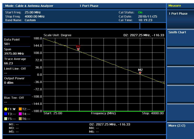
ケーブルおよびアンテナテスト - 1ポート位相
