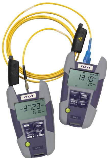
SmartPocket OMK-3x 光テストキットには、OLS-3x 光源、OLP-3x パワーメーター、その他の付属品が含まれています
