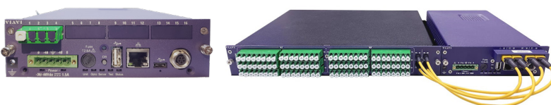
ダークファイバーおよび点灯ファイバー対応のファイバーテストヘッド
